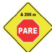
PROXIMIDAD DE SEÑAL RESTRICTIVA (Pare)
