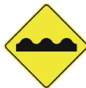
PERFIL IRREGULAR (Irregular)
