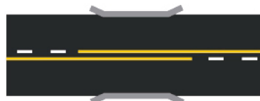
LÍNEAS CONTINUAS Y DISCONTINUAS PARALELAS (Línea discontinua del lado del carril que se circula: traspaso autorizado)
